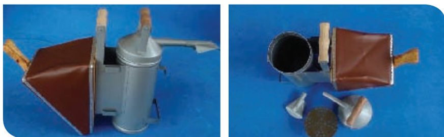
a) Cilindro; b) Fole; c) Tampa com bico; d) Grelha; e) Bico de pato
