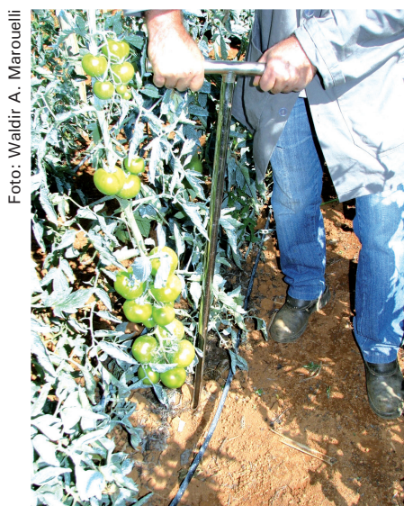
Figura 4. Retirada de amostra de solo com trado tipo meia-cana à 10-30 cm de distância da planta e do gotejador.
