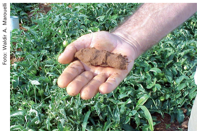
Figura 10. Amostra de solo para avaliação da água disponível, pelo método do tato-aparência, após ser comprimida com a mão.
