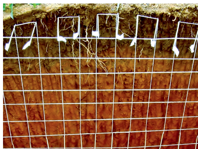
Figura 3. Trincheira aberta perpendicularmente à fileira de plantas para avaliação visual, com auxílio de retículas de 10 cm x 10 cm, da profundidade efetiva do sistema radicular do tomateiro.
