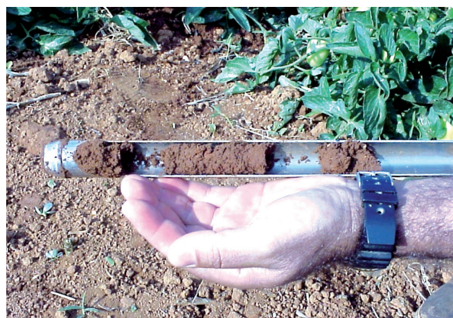
Figura 8. Amostra de solo com 5-7 cm de comprimento, retirada com trado tipo meia-cana, para avaliação da água disponível.
